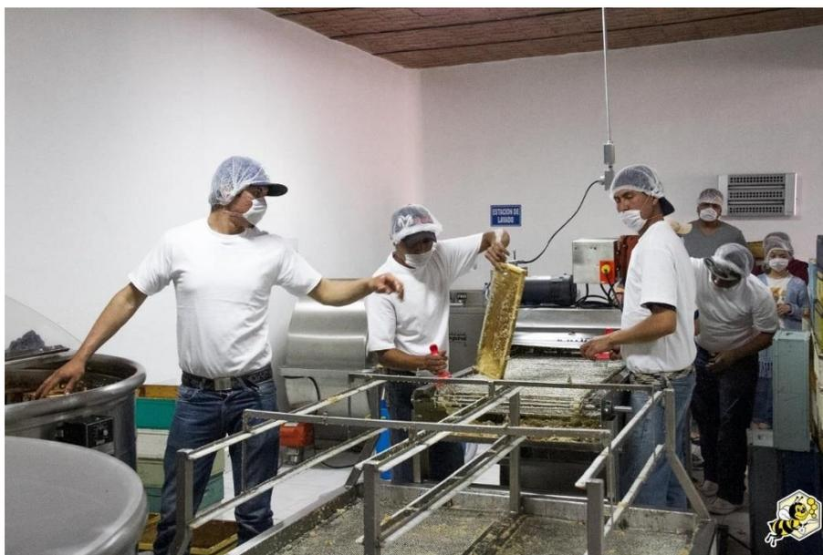
Figura 13. Proceso manual del traslado de los bastidores para el llenado de la centrifugadora.<sup>22</sup>
