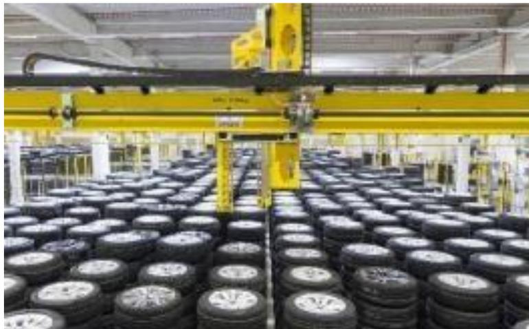
Figura 10. Robot Cartesiano, Aplicación industrial para el manejo de material.<sup>17</sup>
