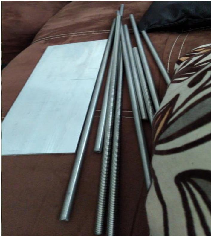
Fig. 23: Husillos y guías de 8mm radio x 50cm obtenidos para el ensamblaje.
