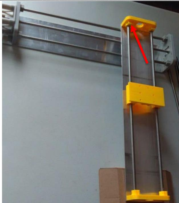
Fig.24: Soportes para las guías lineales, 2 por eje. Junto con guías lineales de 50 cm de largo.
