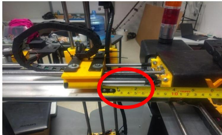
Figura 45. Desplazamiento eje Y
