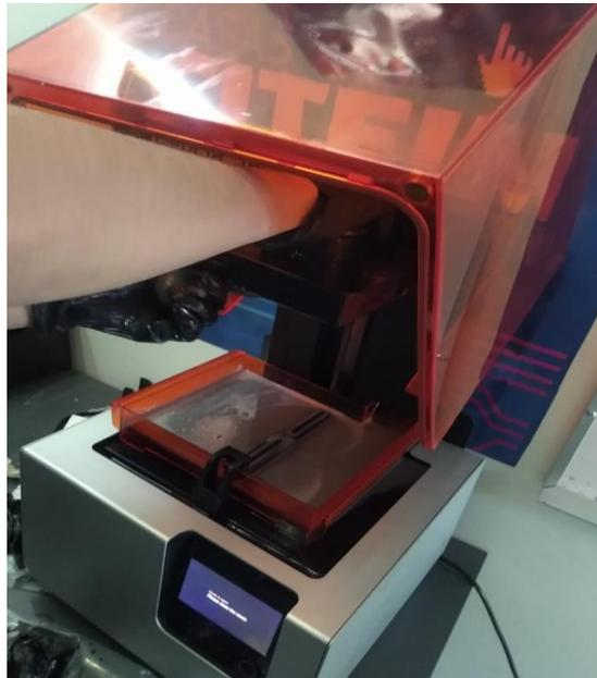
Fig.28: pieza lista siendo retirada de la impresora en 3D
