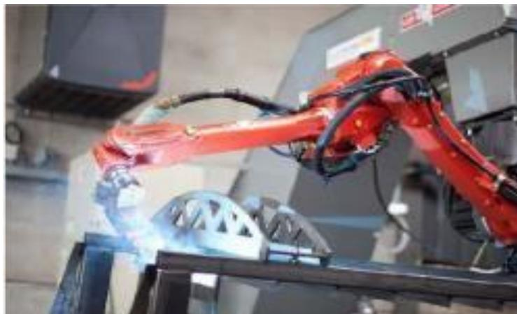
Figura 3. Se ilustra un brazo robótico industrial en el área de soldadura para un proceso en serie.<sup>7</sup>
