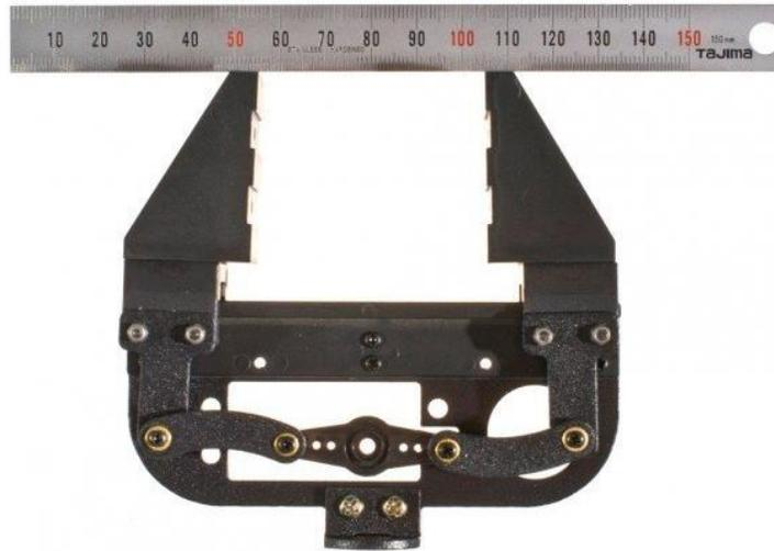
Fig.32: gripper utilizado en el elemento terminal encargado de sujetar los bastidores.
