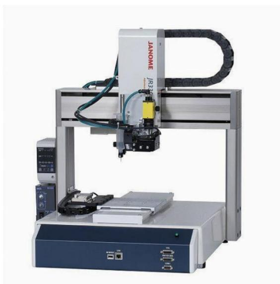
Figura 8. Robot Cartesiano, con aplicación a la industria eléctrica.<sup>14</sup>
