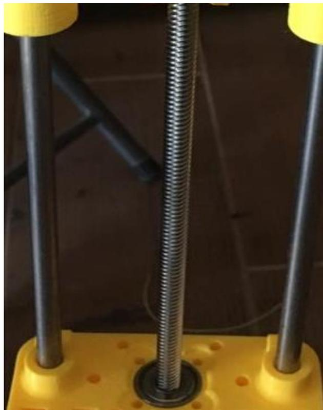
Fig.22 Husillo de 8mm de radio x 50cm empleado como transmisión mecánica en el robot cartesiano.
