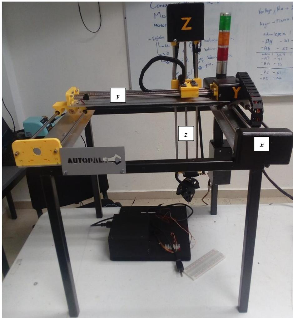
Fig.35: Parte mecánica ensamblada con cada uno de sus ejes x,y,z.
