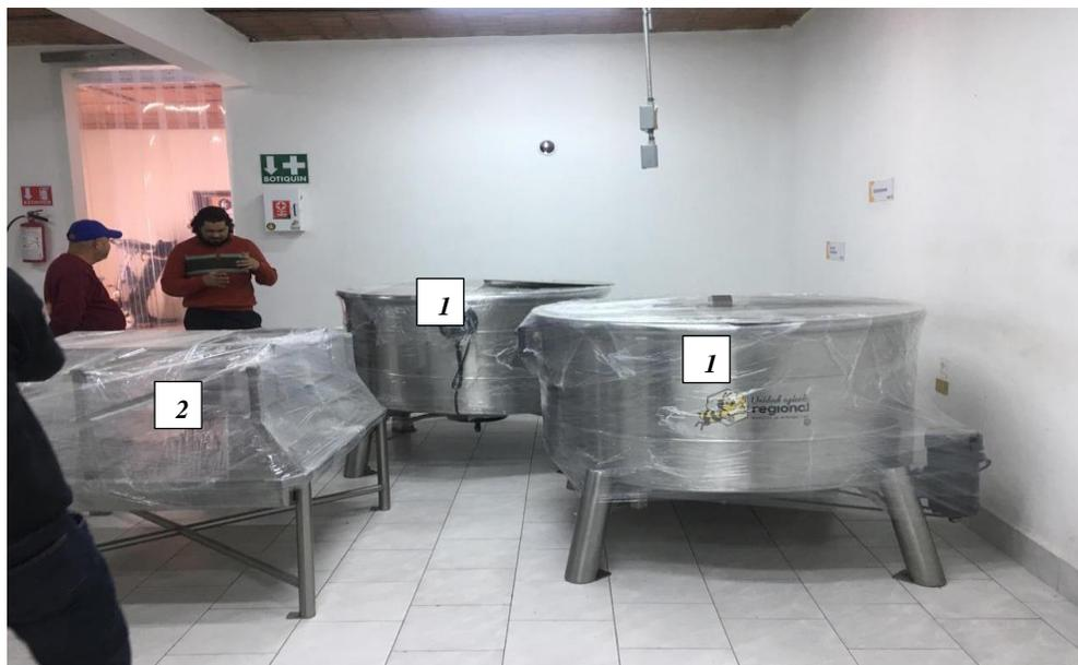
Fig. 18: área de trabajo donde se encuentran dos centrifugadoras (1), rack donde colocan los bastidores de miel.
