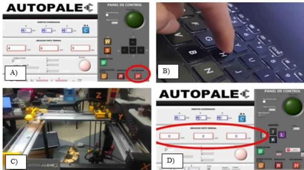
Figura 41. Se muestra A) el panel maestro, indicador “H”, B) el operador presionando la tecla “H”, C) El autómatas yendo a su punto inicial y D) los indicadores de posición para cada eje.
